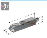
Туре 9221А... Туре 9223А... Technical Data Measuring range kΝ 0 ... 10 0 ... 2,5 Overload kΝ 12 3 Sensitivity pC/N -4,5 -3,3 Dimensions l x w x h mm 72,3 x 12,6 x 9,5 30 x 6 x 6 Cable length 0,2 / 0,4 / 0,6 / 0,8 / sp\* 0,2 / 0,4 / 0,6 / 0,8 / sp\* m Exchangeable cable yes yes Connector Fischer 1 pin neg. Fischer 1 pin neg. Service temperature °C -50 ... 200 -40 ... 150
