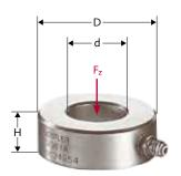
Technical data Туре 9001А Туре 9011А Туре 9021А Туре 9031А 0 ... 15 Measuring range kΝ 0...7,5 0 ... 35 0 ... 60 0 ... 3,5 0 ... 35 Calibrated meas. ranges kΝ 0 ... 0,75 0 ... 1,5 0...6 0...7,5 0 ... 15 0....60 ≈1,8 ≈3,5 Rigidity kN/µm ≈1 ≈6 14,5 D mm 10,3 22,5 28,5 d 4,1 6,5 10,5 13 mm Н 10 mm 6,5 8 11 Weight 7 20 36 3 g
